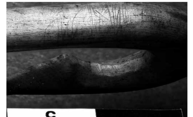
Рис. 5. Детали макроизноса на внешнем крае первой трети стержня экспериментального крючка, использовавшегося для ловли судака. (Фото Е.Ю. Гири)
