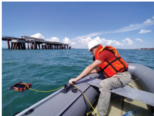
Рис. 5. Тамань 2023. Обследование цели с использованием подводного дрона
