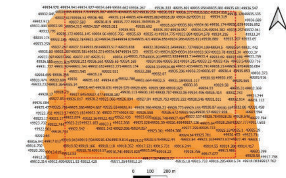
Рис. 19. Тамань 2023. Общая схема распределения геомагнитного поля с числовыми значениями на участке 3 (шаг 25)
