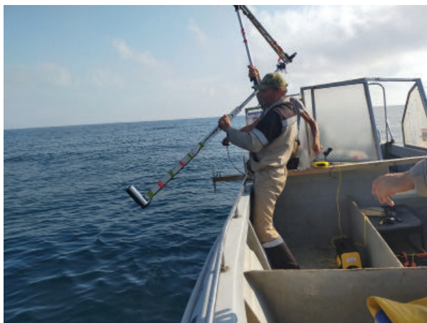
Рис. 3. Тамань 2023. Установка ГБО на судно
