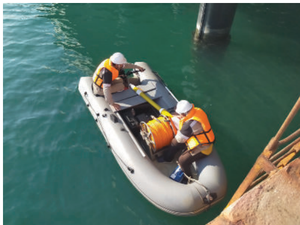
Рис. 4. Тамань 2023. Морская магнитная съемка на акватории
