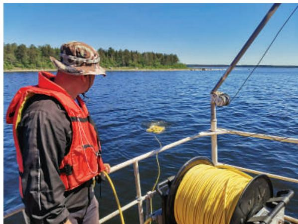
Рис. 5. Приморск. Обследование акватории при помощи телеуправляемого подводного аппарата «Марлин-350»
