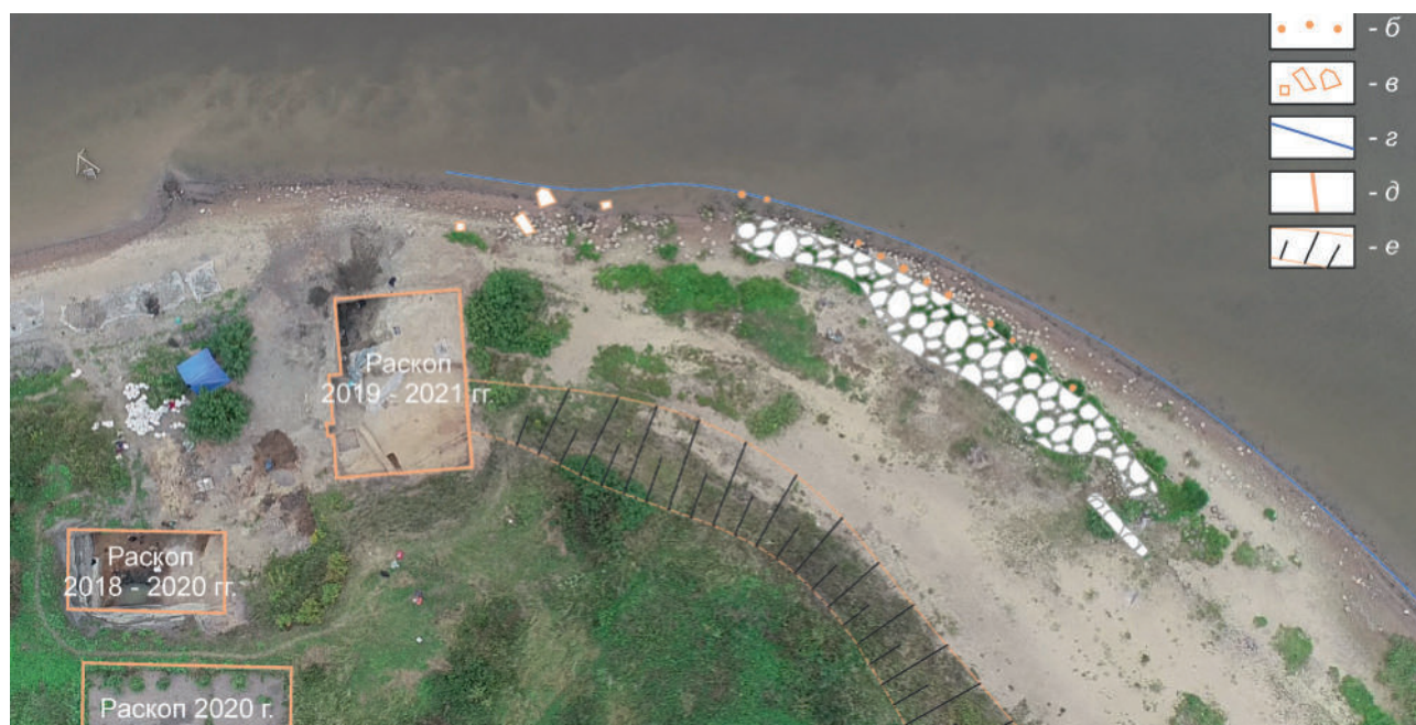
Рис. 10. Наложение тахеометрической съемки участка берега Сиверсова канала и р. Волхов на ортофотоснимок ( а — участки сохранившегося мощения; б — сваи; в — фрагменты горизонтально лежащих бревен; г — урез воды на день съемки; д — край раскопа; е — обрыв берега) (фото С. Е. Торопова, лето 2020 г.)
