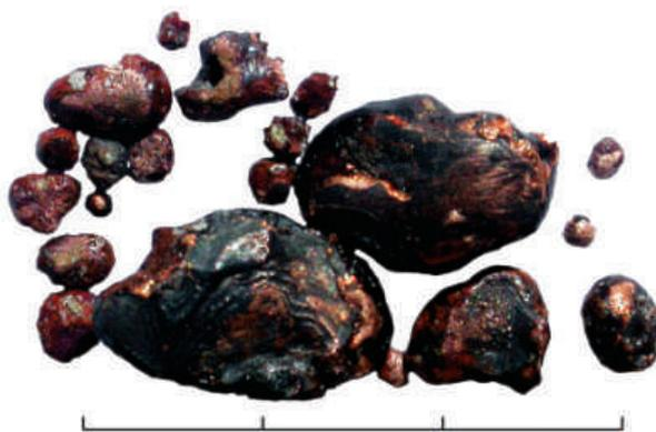
Рис. 4. Слитки меди, полученные в процессе плавки 4. Образец № 7
