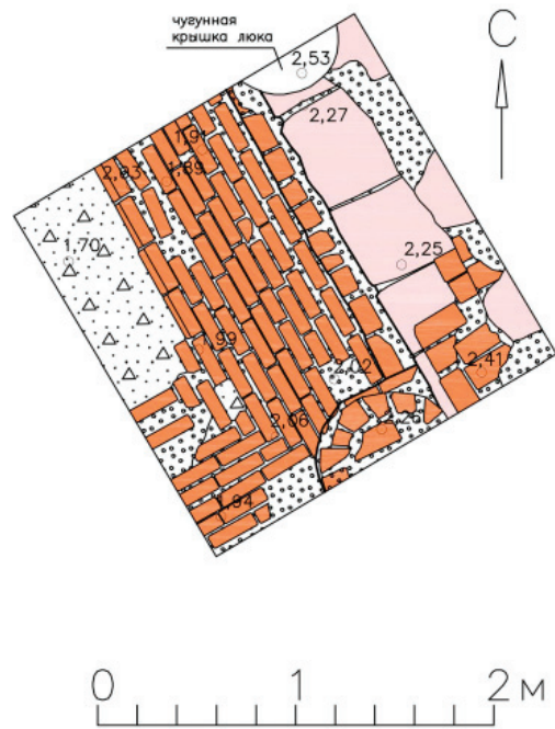
Рис. 6. ВО7л-2014. Шурф 3. План поверхности кирпичного свода
